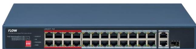
Неуправляемый коммутатор F-SW-EU426POE-V/L с 100 Мбит/с PoE портами и гигабитными портами, которые применяют для обеспечения высокоэффективного доступа к сети и стабильной загрузки данных. Коммутатор поддерживает передачу на большие расстояния, изоляцию портов и функцию PoE-сторожевого таймера.
