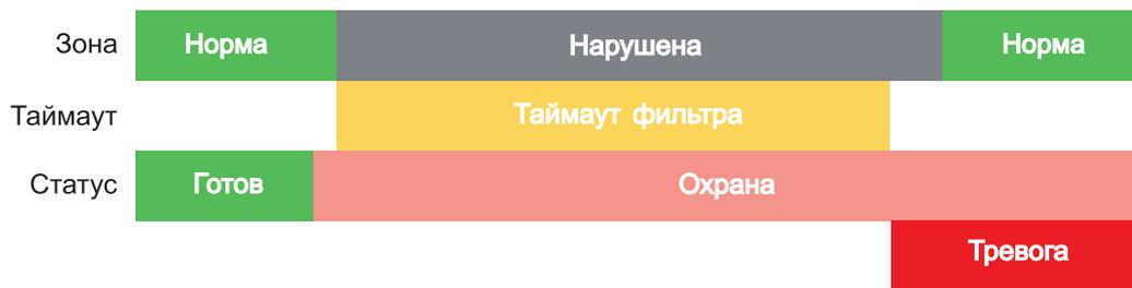
Рисунок 10. Тревога при нарушении по окончании тайм-аута.
