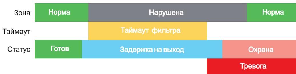
Рисунок 12. Превышен тайм-аут фильтра для зоны периметр во время задержки на выход
