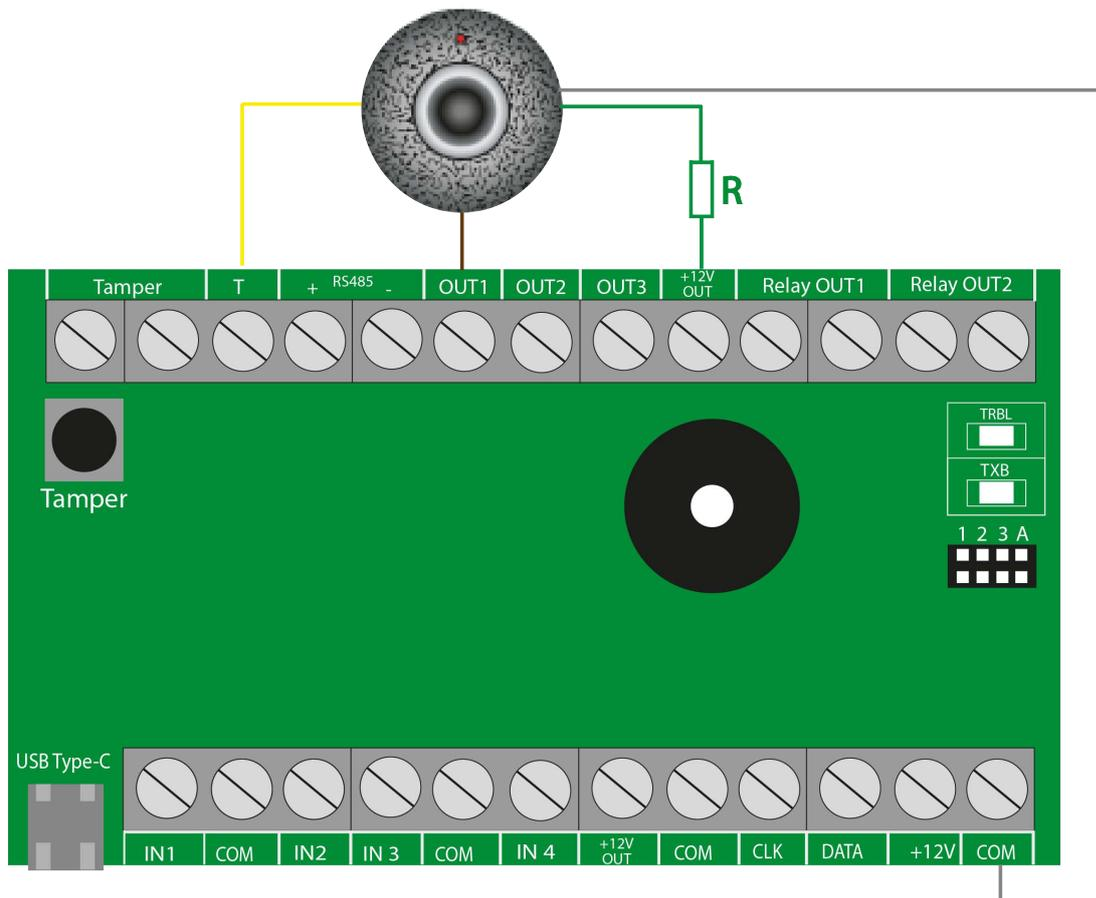
Рисунок 5. Схема подключения на примере ТМ считывателя СТМ-КТ
