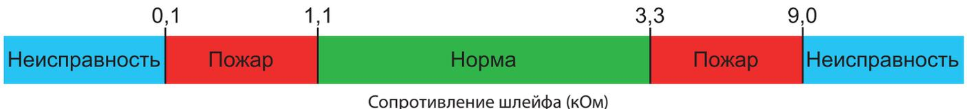
При настройке входа в NV Pro выбрать тип зоны Пожарная (4х-проводный извещатель), при этом требуется установить окончательный резистор номиналом 2.2 кОм.
