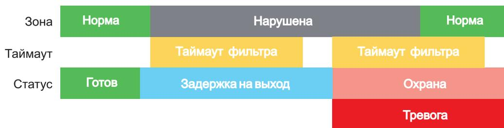
Рисунок 15. Нарушение зоны в момент постановки на охрану.
