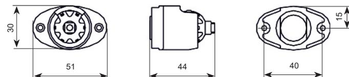
Рисунок 4 – Габаритные и установочные размеры кронштейна
