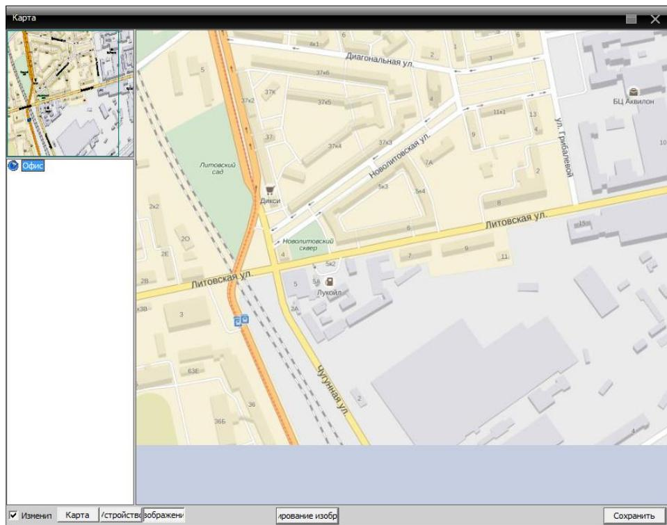
4. Нажмите «Устройства» чтобы перетащить их поканально на карту, имя канала появится на карте.
