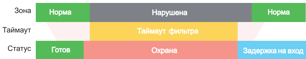
Рисунок 7. Начало задержки на вход по окончании таймаута после нарушения зоны Вход-выход.
