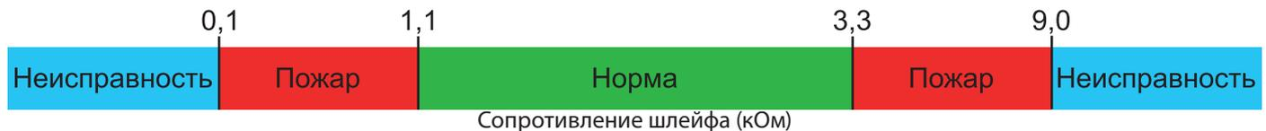
При настройке входа в NV Pro выбрать тип зоны Пожарная (4х-проводный извещатель), при этом требуется установить окончательный резистор номиналом 2.2 кОм.
