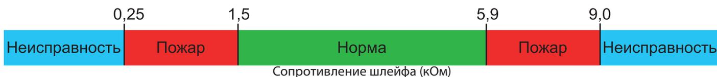
Сработал любой извещатель в течение 2 с - будет отправлен отчет внимание - код E138 выключение питания в шлейфе на 3 с включение питания шлейфа и пауза после включения 2 с. Если в течение минуты зафиксирована сработка любого извещателя на 2 с - будет отправлен отчет тревога код заданный пользователем в NV Pro. Если в течение минуты ни один извещатель не сработал, будет отправлен отчет R138.
