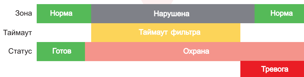
Рисунок 5. Тревога при нарушении по окончании таймаута.
