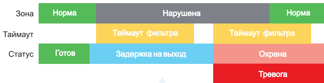
Рисунок 10. Нарушение зоны в момент постановки на охрану.
