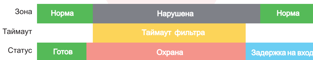
Рисунок 9. Начало задержки на вход по окончании таймаута после нарушения зоны Вход-выход.
